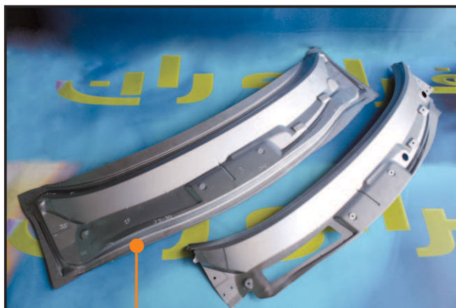
قطعه زیر شیشه خودروی رانا قبل و بعد از برش لیزر
