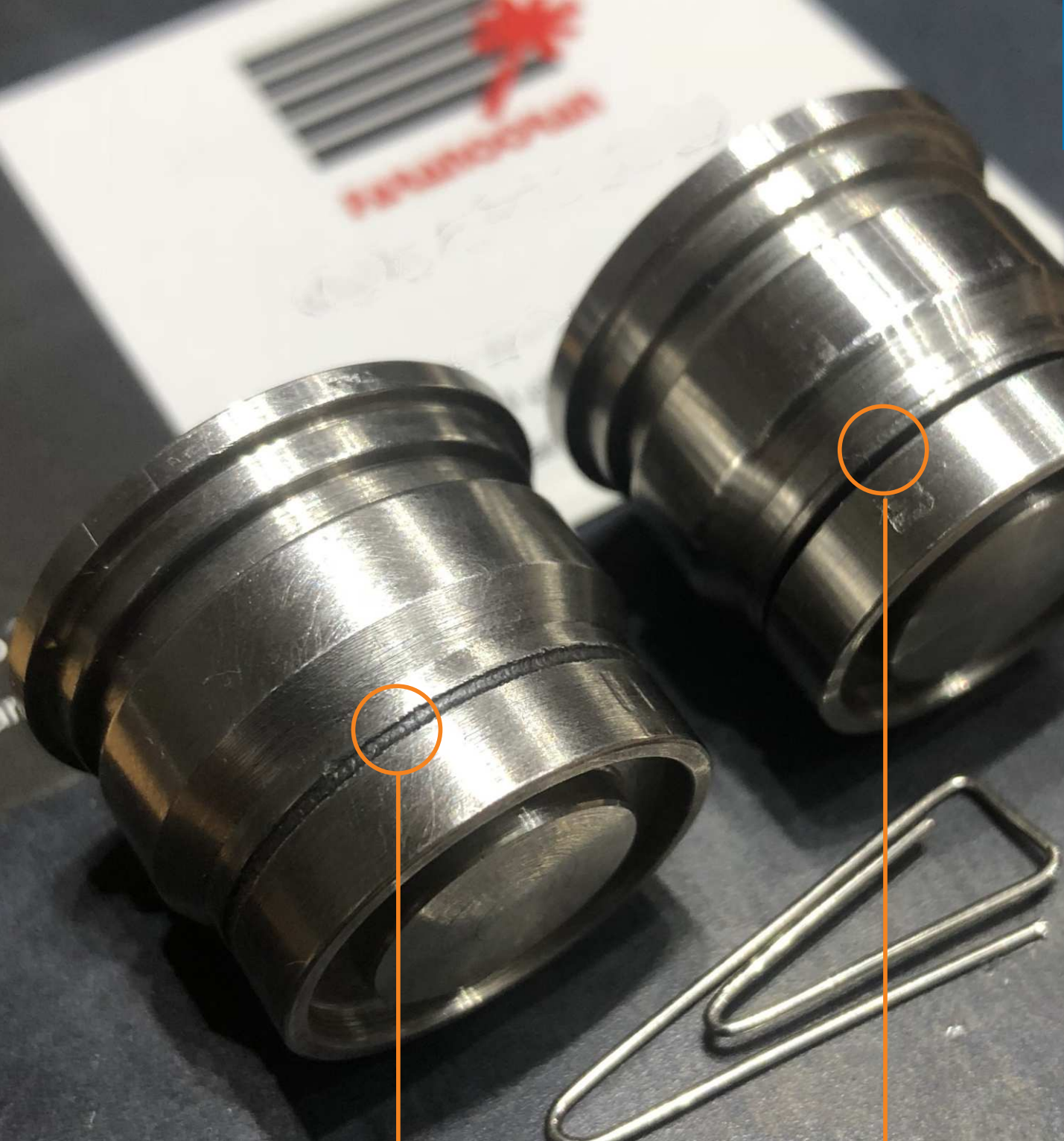
پهنای جوش 0.7mm با کمترین نامیه متأثر از حرارت HAZ
